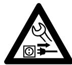
Před všemi pracovními úkony na stroji: Vytáhnout elektrickou vidlici ze síťové zásuvky.
