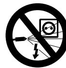
Elektrická zařízení, přípojky a elektrický proud vodící kabely nikdy neostřikovat vysokotlakým proudem vody nebo vodní hadicí – **hrozí nebezpečí zkratu!**
