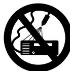
**Jak vlasní stroj, tak ani jiné elektrické spotřebiče nikdy neostřikovat vysokotlakým proudem nebo vodní hadicí – hrozí nebezpečí zkratu!**
