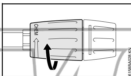
N Seřizovací objímku trysky otočit na doraz ve směru "CHEM" = nízkotlaký provoz.
